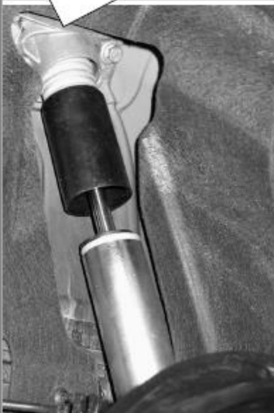
Mitgelieferte Höhenverstellung wird ohne Gummlunterlage zwischen Karosserie und Feder oben montiert.
